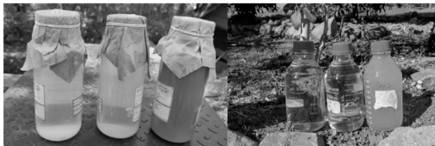
Figura 3. Fotografías de muestras de AG de las tres etapas analizadas. De derecha a izquierda, botellas con agua extraída desde el sedimentador primario justo antes de entrar al HFV, la siguiente tomada desde el sedimentador de salida del HFV y la tercera desde el tanque de acumulador final.
